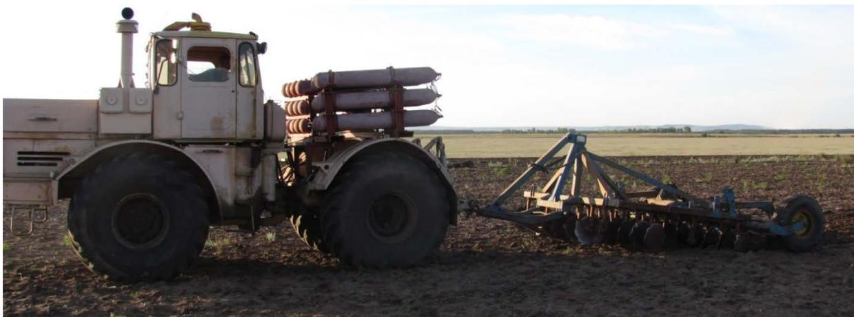
Рисунок 4.10 – Экспериментальный трактор в агрегате с дисковой бороной БН-3,2
