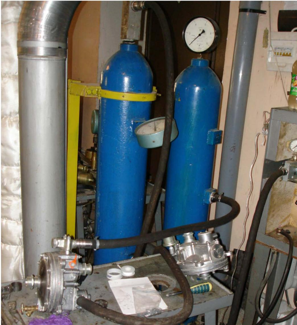
Рисунок 4.6 – Универсальный стенд для проверки и регулировки газовой аппаратуры мод. ИС-001
