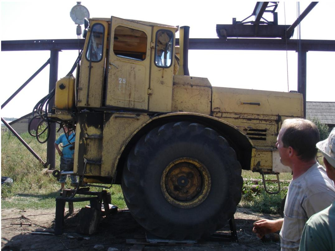
Рисунок 4.23 – Исследования по определению координат центра тяжести передней полурамы трактора К-700А
