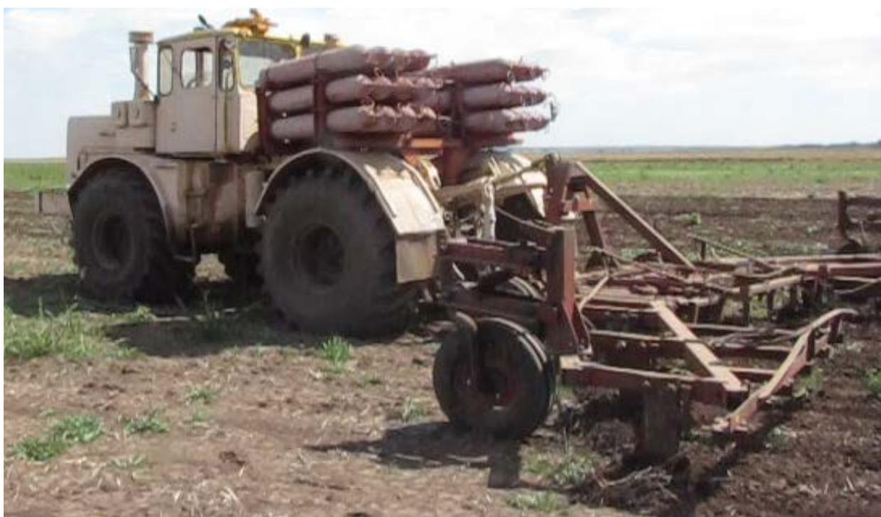
Рисунок 4.8 – Экспериментальный трактор в агрегате с культиватором КПШ-9
