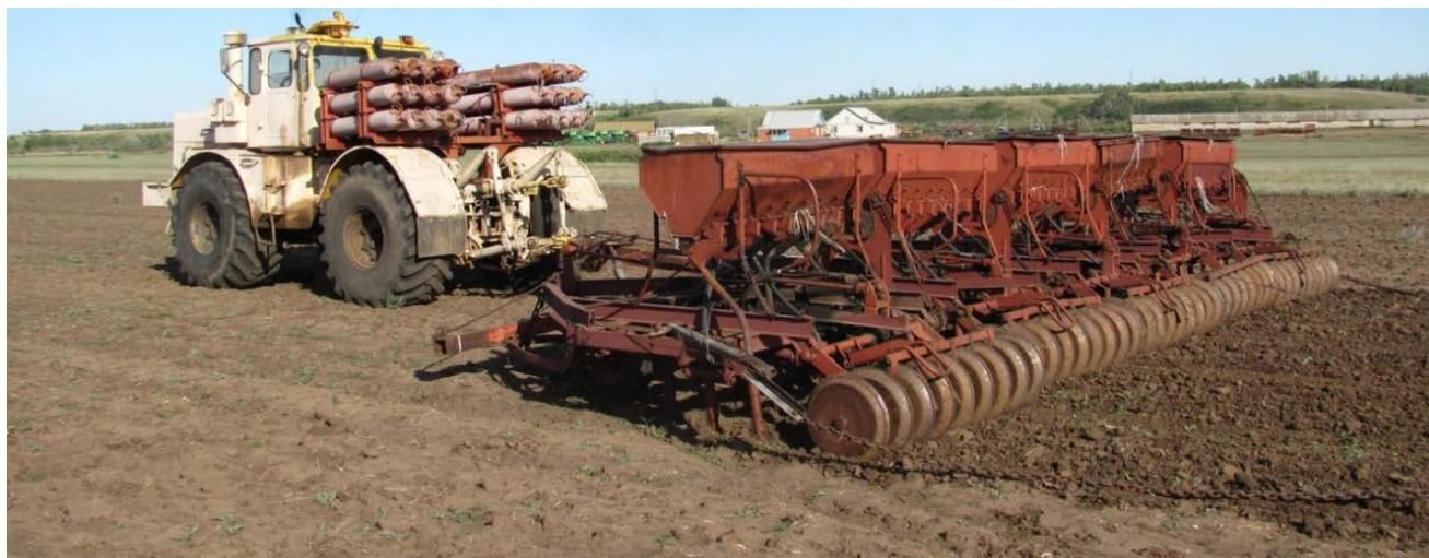
Рисунок 4.9 – Экспериментальный трактор в агрегате с сеялками СЗС-2,1
