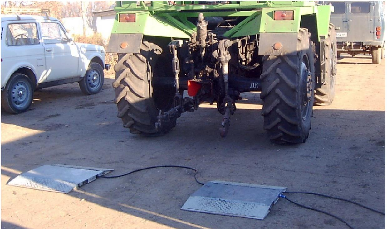
Рисунок 2.5 – Весы автомобильные переносные «Мера ВП-10».
