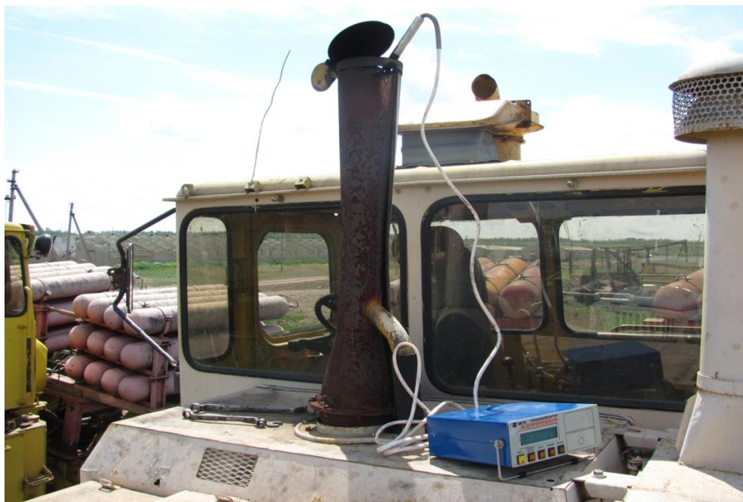
Рисунок 4.16 – Проведение экологических исследований при эксплуатации трактора К-700А, оснащенного эжекционной системой подачи газообразного топлива
