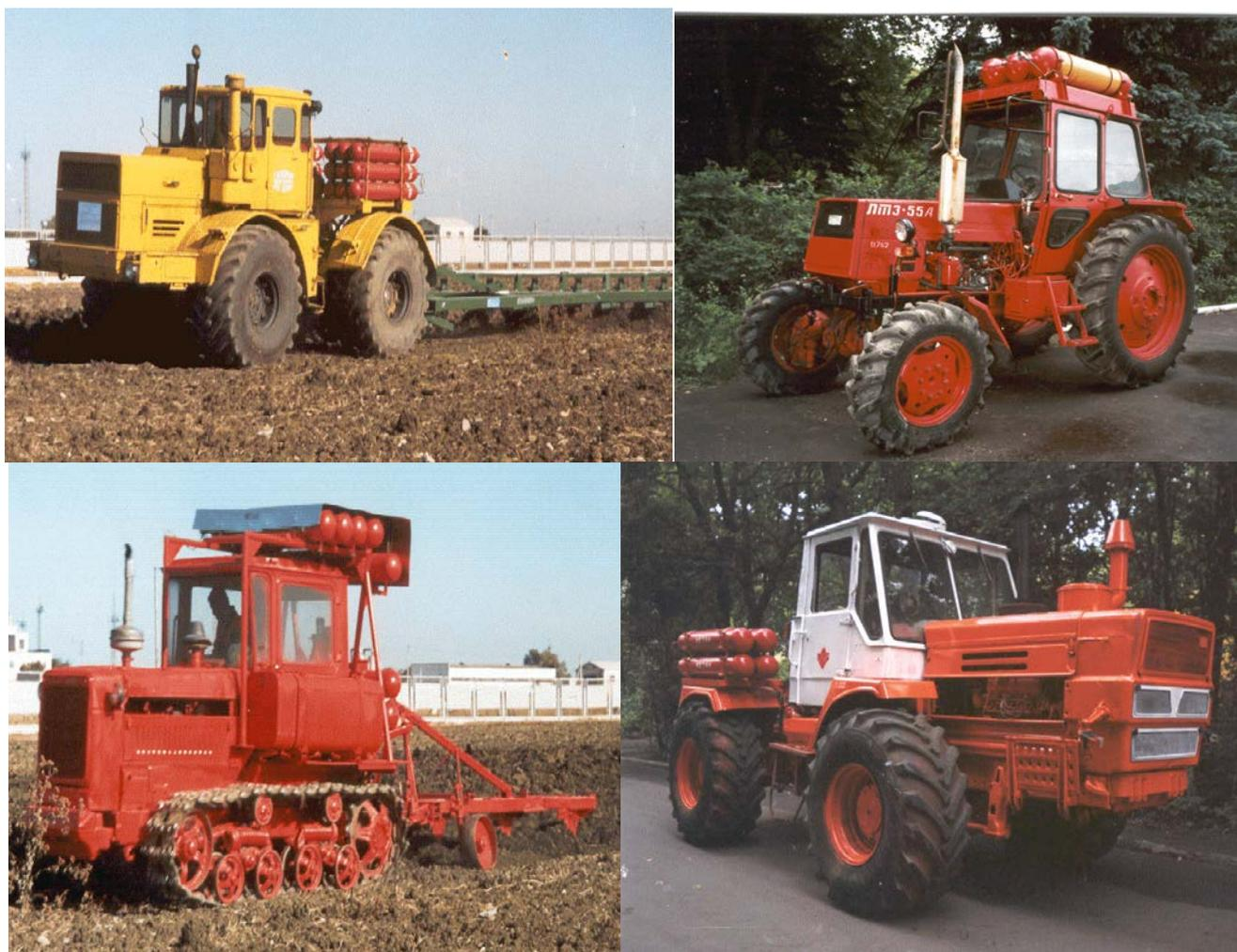
Рисунок 1.5 – Сельскохозяйственные тракторы с газобаллонным оборудованием
