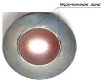
Рис. 7. Распределение упрочненной зоны
