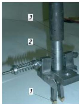
Рис. 5. Инструмент для ИЭМЗ: 1 – упрочняющий зуб; 2 – оправка; 3 – токоизоляционная втулка
