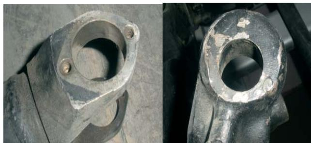
**Рис. 2. Детали, имеющие неравномерный износ отверстия: а – фрагмент вилки карданной передачи; б – фрагмент поворотного кулака автомобиля КамАЗ**
