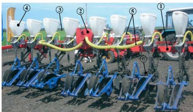
Рис. 1. Комбинированный посевной агрегат: 1 – рама; 2 – вентилятор; 3 – приводной вал; 4 – семенной ящик с высевателями; 5 – воздухопроводы; 6 – секция
