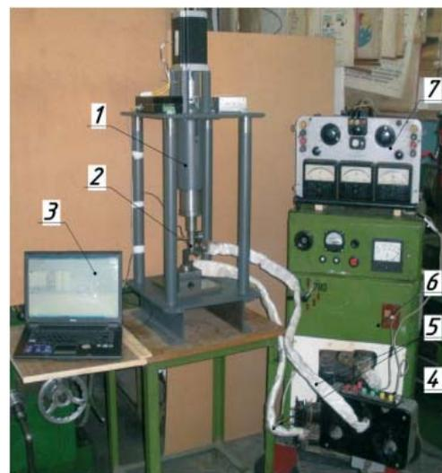
Рис. 6. Компонировка оборудования для ИЭМЗ отверстий: 1 – установка для электромеханической обработки отверстий; 2 – инструмент для ИЭМЗ; 3 – персональный компьютер; 4 – трансформатор тока; 5 – токоподводящие кабели; 6 – установка УЭМО-5; 7 – универсальный измерительный комплекс К-50
